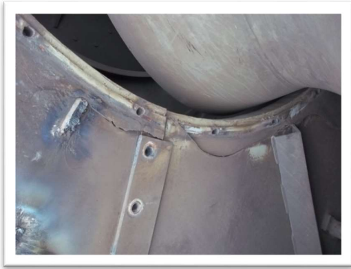
Fisuras en el soporte de óido, se repararon y reforzaron.
